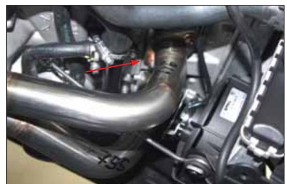
**Solo in caso di montaggio del kit collettori 3215932:** fissare i collettori ai cilindri, utilizzando i dadi originali, senza stringere.
