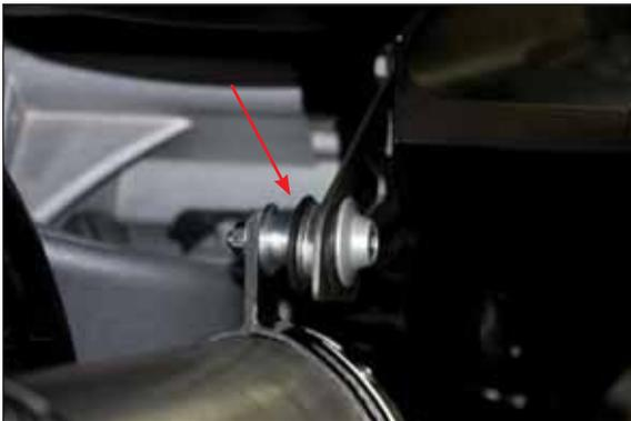
Innestare il silenziatore sul raggruppamento e fissare il terminale alla staffa di supporto, mediante bulloneria fornita e spessore esterno originale come mostrato in foto (lo spessore fornito va nella parte interna, tra staffa originale e fascetta di sostegno).
