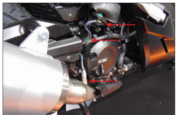
Avvitare la sonda lambda, riconnettere il cablaggio e riposizionare il cavo come in origine
