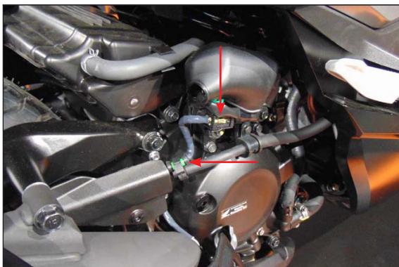
Liberare il cavo e disconnettere il cablaggio della sonda lambda
