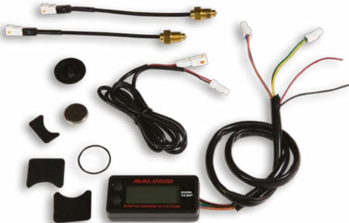
Este instrumento permite monitorizar la temperatura del líquido refrigerante a través de dos sensores colocados en dos diferentes posiciones del circuito de refrigeración y es capaz de medir la temperatura del líquido refrigerante tanto en entrada como en salida para evaluar el correcto funcionamiento del sistema. Está prevista la posibilidad de montar los dos sensores de modo que uno sea elegido para el control de la temperatura del líquido refrigerante y el otro para la del ambiente externo.
