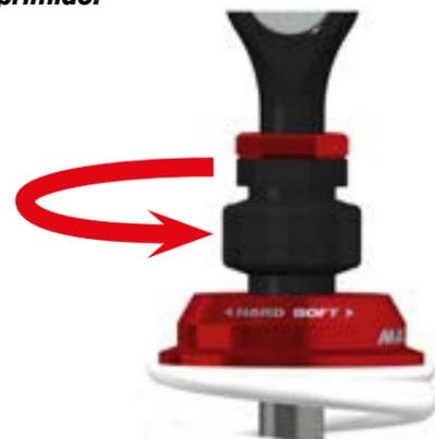
**3** Regulación de la precarga muelle para aumentar o disminuir la carga "inicial" del amortiguador y determinar en consecuencia la mayor o menor rigidez inicial del sistema, es decir los esfuerzos necesarios para poner en funcionamiento la suspensión regulando agilidad, manejabilidad y estabilidad del vehículo.
