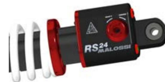
El **RS24/10-R** está dotado de dos depósitos de nitrógeno para la compensación del vástago. Este sistema permite modificar totalmente las curvas de carga en función de la presión de cada cámara es decir las modalidades de movilización durante las fases de compresión y de extensión y garantiza mayor compactibilidad al amortiguador respecto al sistema con depósito único externo, menores fricciones y mayor dispersión del calor producido por el funcionamiento del sistema.
