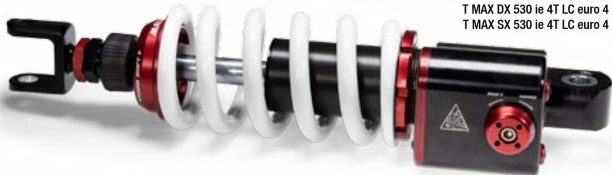
El amortiguador posterior **RS24/10-R** para maxi scooter está compuesto por un único cuerpo atravesado por un circuito hidráulico de nueva concepción que permite integrar todas las regulaciones manteniendo las mismas dimensiones del amortiguador original, sin disminuir el dimensionamiento general del freno hidráulico.
