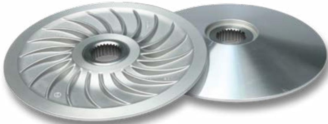
**NB :** dans le cas où le Ventilvar est monté en même temps que le Multivar Malossi MHR il faut **ABSOLUMENT NE PAS UTILISER** la rondelle fournie dans le kit variateur afin que la courroie n'aille pas toucher le carter.
