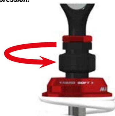
**3** Réglage de la précharge du ressort pour augmenter ou diminuer la charge « initiale » de l'amortisseur, et, par conséquent, déterminer la rigidité initiale supérieure ou inférieure du système, c'est-à-dire l'effort nécessaire pour démarrer la suspension en réglant l'agilité, la maniabilité et la stabilité du véhicule;
